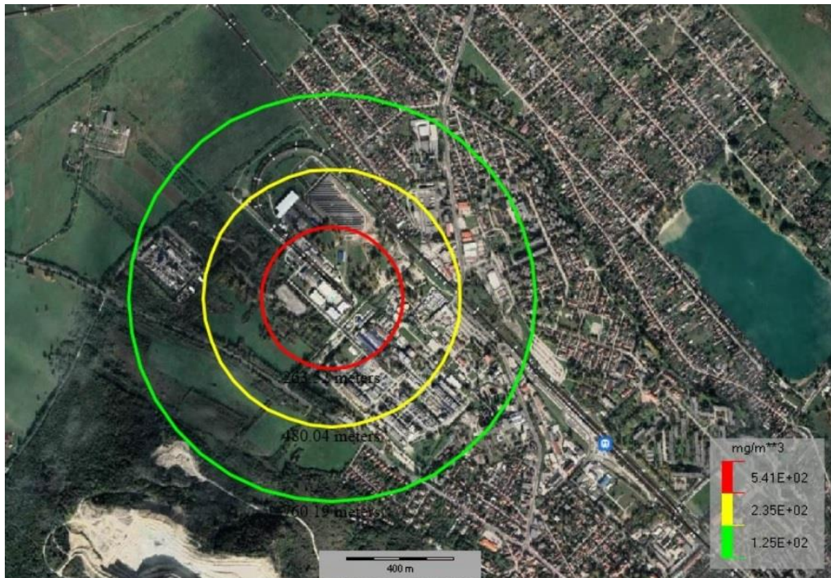
Nitrogén-oxid kibocsátás izokockázati görbéi
