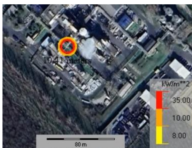
A DOM9 szcenárió megvalósulásának következménye tócsatűz esetén
