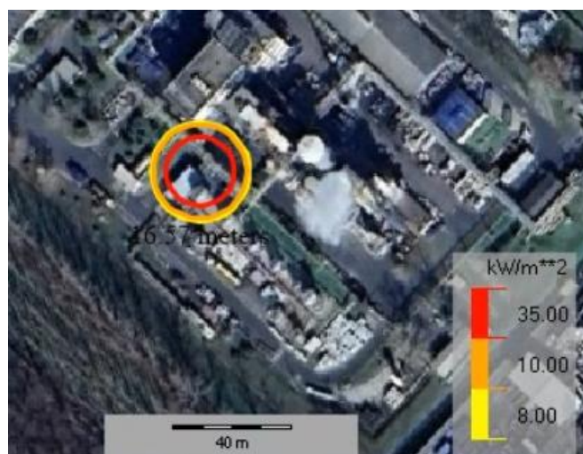
A DOM10 szcenárió megvalósulásának következménye tócsatűz esetén
