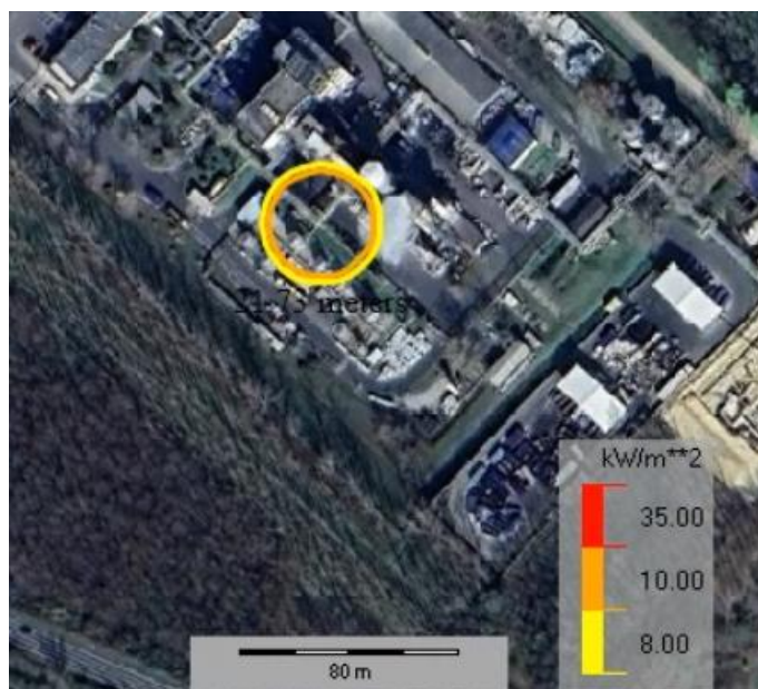
A DOM9 szcenárió megvalósulásának következménye jettűz esetén
