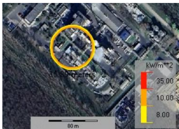
A DOM10 szcenárió megvalósulásának következménye jettűz esetén
