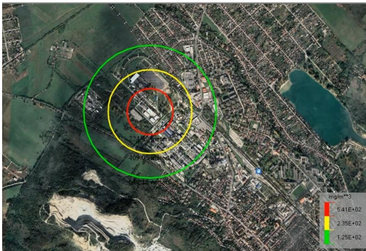
Nitrogén-oxid kibocsátás izokockázati görbéi
