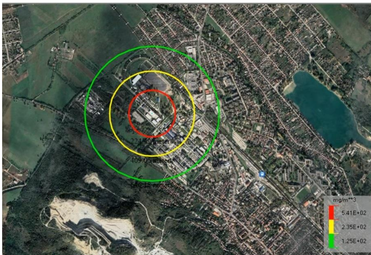
Nitrogén-oxid kibocsátás izokockázati görbéi
